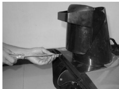
2. Sikre at greb på udkaster står i linje med beslaget. Fastgør med skrue på forside.
