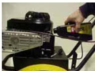
Zdjąć świecę zaplonową oraz wlać olej silnikowy do otworu na świecę. Pociągnąć 4 – 5 razy za linkę startową oraz ponownie założyć świecę zaplonową. Wolno pociągnąć za linkę startową do momentu napotkania na opór. W ten sposób nastąpi zamknięcie zaworu zasysania oraz wydmuchu, co zapobiegnie rdzewieniu wewnętrz cylindra.
