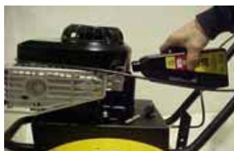
Vyšroubujte zapalovací svíčku a otvorem po svíčce nakapejte do spalovacího prostoru několik kapek oleje. 4-5x zatáhněte za startovací šňůru a svíčku našroubujte zpět. Pomalu táhněte za startovací šňůru, až ucítíte odpor. V této poloze je sací i výfukový ventil uzavřen, čímž se předejde tvorbě rzi ve válci.
