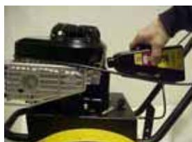
Extraer todo el combustible del aparato. Dejar en marcha el motor, hasta que el carburador esté totalmente vaciado (el motor se detiene por sí solo). Si, durante un largo periodo de tiempo, permaneciese combustible dentro del tanque, podría atascarse el carburador debido a eventuales impurezas de la gasolina. De esta forma se dificultaría el arranque del motor y podría disminuir la potencia del aparato.
