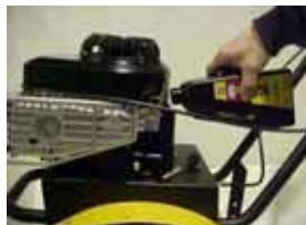
Estrarre la candela d'accensione e versare alcune gocce di olio per motore nella relativa apertura. Tirare 4-5 volte la fune d'accensione e reinserire la candela. Tirare lentamente la fune d'accensione fino a quando non si sente una leggera resistenza. In questo modo la valvola di aspirazione e di scarico si chiudono impedendo così la formazione di ruggine nel cilindro.
