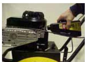
Αφαιρείτε το μπουζί και βάζετε μερικές σταγόνες λάδι κινητήρων στην υποδοχή μπουζί. Τραβάτε 4-5 φορές από το σχοινί εκκίνησης και τοποθετείτε πάλι το μπουζί. Τραβάτε αργά από το σχοινί εκκίνησης, μέχρι να αισθανθείτε μια αντίσταση. Με τον τρόπο αυτό κλείνει η βαλβίδα αναρρόφησης και η βαλβίδα εξώθησης, πράγμα που εμποδίζει τη δημιουργία σκουριάς στον κύλινδρο.
