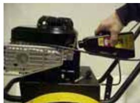
Entfernen Sie den gesamten Brennstoff aus dem Gerät. Lassen Sie den Motor laufen, bis der Vergaser geleert ist (der Motor stoppt von alleine). Bleibt über einen längeren Zeitraum Brennstoff im Tank , kann der Vergaser durch eventuelle Verunreinigungen im Benzin verstopfen, wodurch das Starten des Motors erschwert und die Leistungsfähigkeit beeinträchtigt werden kann.
