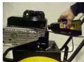
Démonter la bougie. Verser quelques gouttes d'huile de moteur dans l'ouverture de la bougie. Tirer la cordelette de démarrage 4 à 5 fois et remettre la bougie. Tirer lentement sur la cordelette de démarrage jusqu'à ce que vous rencontriez de la résistance. Cela ferme la soupape d'admission et d'échappement, empêchant ainsi la formation de rouille dans le cylindre.
