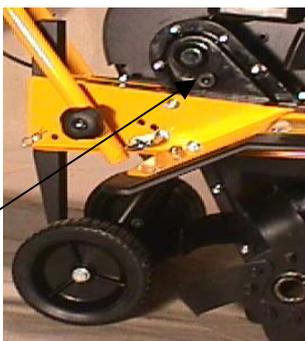
Das Getriebe der Motorhacke ist serienmäßig mit 0,2 l. TEXACO Multifax 283 EPOO-Öl gefüllt. Ein Ölwechsel ist nicht notwendig.
