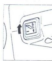
Aftrydelse af motoren, slip gasknappen og still stopkontakten på "O". Hvis motoren ikke star-
