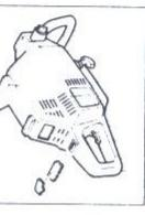
Fjern gummibanden og underseg luftfilter.
